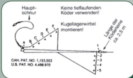
Die Bestimmung der Schlepptiefe erfolgt durch Einhängen von Hauptschnur und Köderleine in die Löcher A – F bzw. 1 – 5 (150 cm-Schritte)
