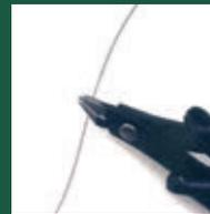
2. Stahlseil im ausgeglühten Bereich schneiden
